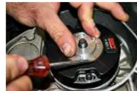
**DESSERRE LE BLOC PISTON ET SERVEZ VOUS EN COMME PIGE EN TOURNANT LE VILEBREQUIN POUR TROUVER LE POINT MORT HAUT. AU POINT MORT HAUT FAIT COINCIDER LES REPERES ROUGE DU STATOR ET DU ROTOR ET SERRER LE ROTOR AVEC LA RONDELLE ET L'ECROU D'ORIGINE.**
