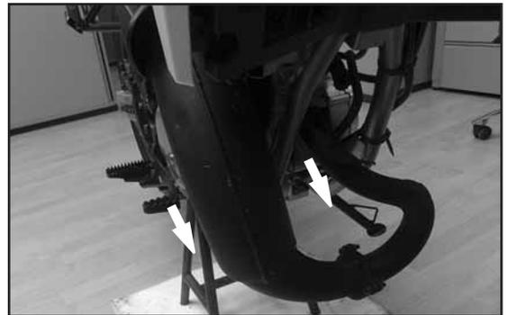
5. Pour déconnecter le catalyseur d'échappement, enlever les trois vis (8). Si vous déconnectez le catalyseur d'échappement, toujours remplacer le joint (9) par un neuf.
