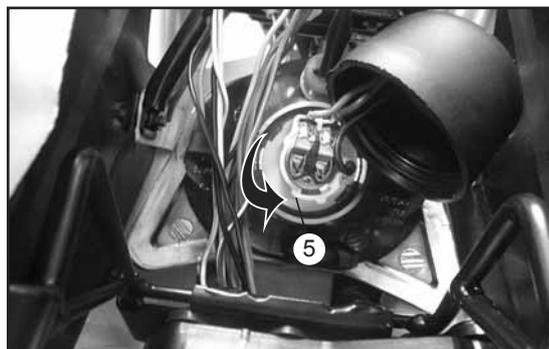
5. Enlever l'ampoule (7) et tourner dans le sens des aiguilles d'une montre jusqu'à ce que vous puissiez la retirer.
