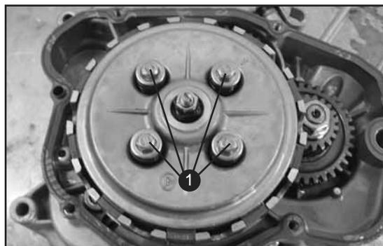
2. Enlever le plateau de pression de l'embrayage (2) et les plaques de friction (3).
